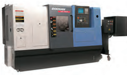
DOOSAN LYNX 220 LM con assi motorizzati max diametro tornibile 350 lunghezza 500
