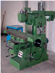
FRESATRICE UNIVERSALE con testa birotativa e frontale x 1.200 y 450 z 500
